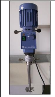
Fig. III. 1: Paste mixer (LABORTECHNIK RW 20.n)
